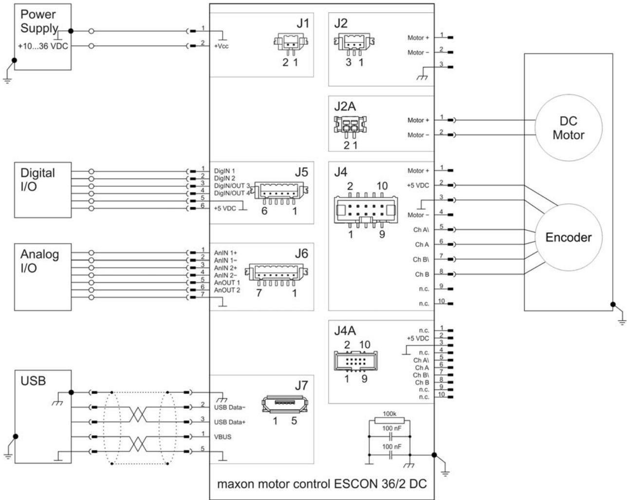
Figura 4-30 maxon DC motor con encoder – cable separado (J2A / J4)
