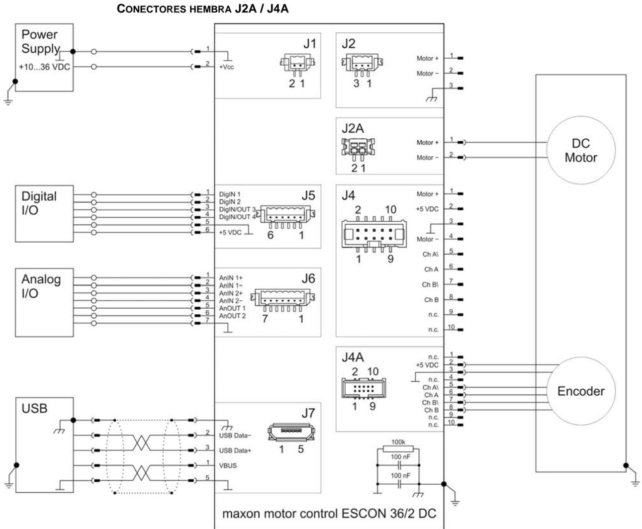
Figura 4-31 maxon DC motor con encoder – cable separado (J2A / J4A)
