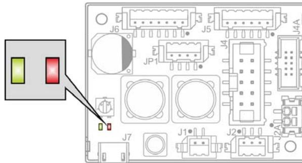
Figura 3-24 LEDs – Lugar de montaje
