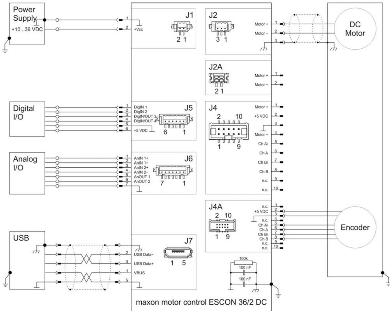
Figura 4-29 maxon DC motor con encoder – cable separado (J2 / J4A)
