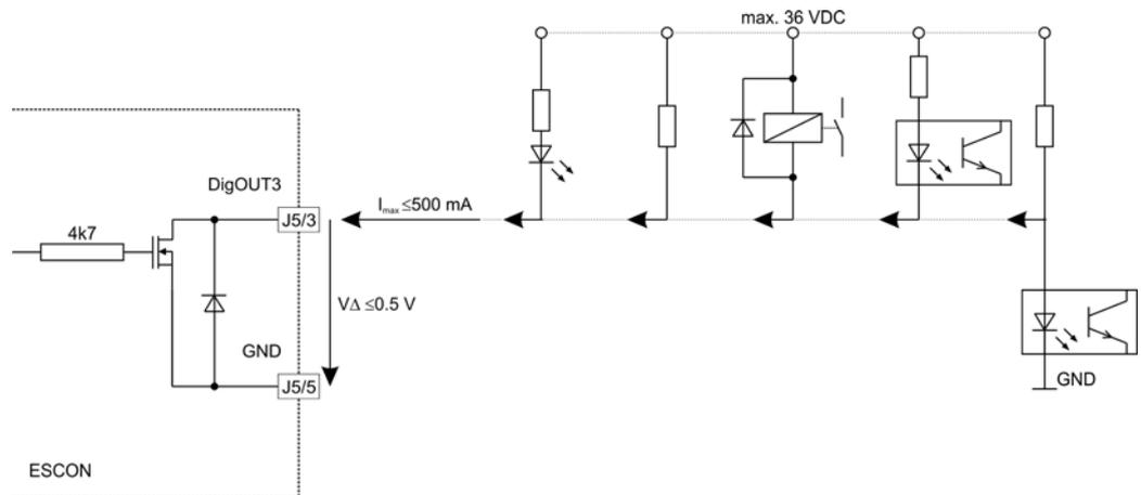
Figura 3-15 Ejemplos de conexión de DigOUT3 (similar también para DigOUT4)
