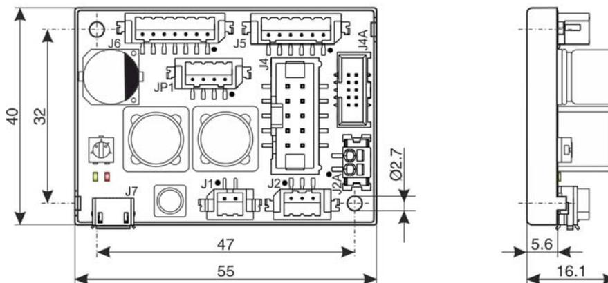
Figura 2-2 Diagrama de medidas [mm]
