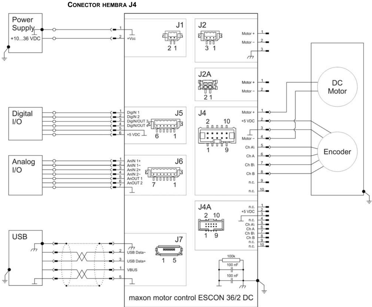
Figura 4-32 maxon DC motor con encoder – cable plano integrado (J4)
