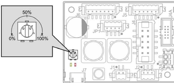
Figura 3-23 Potenciómetro P1 – Lugar de montaje y rango de ajuste
