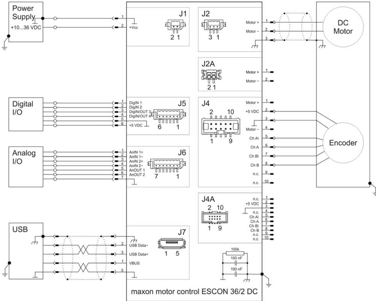
Figura 4-28 maxon DC motor con encoder – cable separado (J2 / J4)
