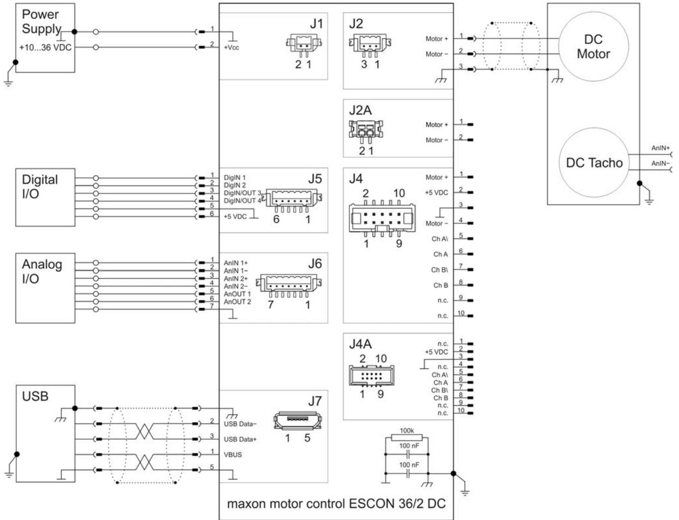
Figura 4-27 maxon DC motor con tacodinamo de CC (J2)
