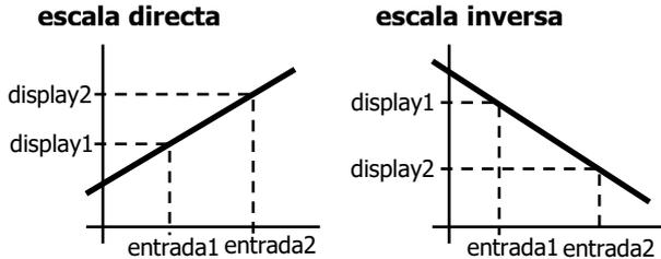
**En procesos lineales** esto se consigue programando dos coordenadas (entrada1, display1) y (entrada2, display2), entre las cuales se establece una relación lineal donde a cada valor de la señal de entrada le corresponde un valor de display.
