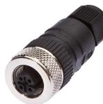
caja de conexiones, recto, autocofeccionable, conexión con tornillos, Ø3-6,5mm, 4a, 240v, -25-90°C, m12 hembrilla 4polos, ip67, pbt
