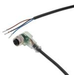
cable de conexión, 2m, m12 hembrilla 3polos acodado, extremo del cable libre, 3x0,34mm<sup>2</sup>, pur (poliuretano), Ø4,3mm, -30-90°C, ip67, con indicador led, apto para cadenas de arrastre y torsión, aceites y lubricantes refrigerantes, área de soldadura,...
