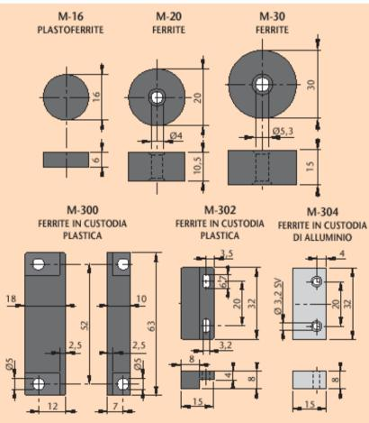
N.B.: A richiesta sono disponibili magneti di diverse dimensioni. Il modello M-300 è fornibile senza custodia plastica, solo ferrite mod. M-300F dim. 39 x 15 x 8mm.
