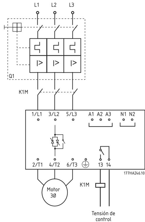
Ejemplo 3 - MCD 201 instalado con disyuntor e interruptor automático de línea con detección de sobrecarga.
