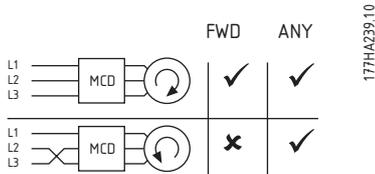
El propio MCD 202 es insensible a la rotación de fase. Esta función permite limitar la rotación del motor sólo hacia una dirección. Fije la protección de acuerdo con los requisitos de aplicación.
