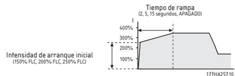
Normalmente, el modo de arranque de rampa de intensidad se utilizará bajo dos circunstancias.
