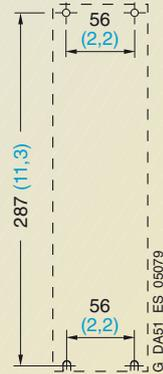
Fijación con tornillos M4
