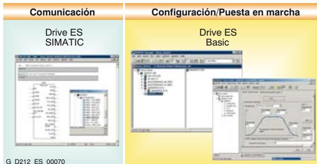
Drive ES es el sistema de ingeniería que permite integrar de forma sencilla, rápida y económica los accionamientos de Siemens en el entorno de automatización SIMATIC en términos de comunicación, configuración y gestión de datos. La base es la interfaz de usuario del Administrador STEP 7.
